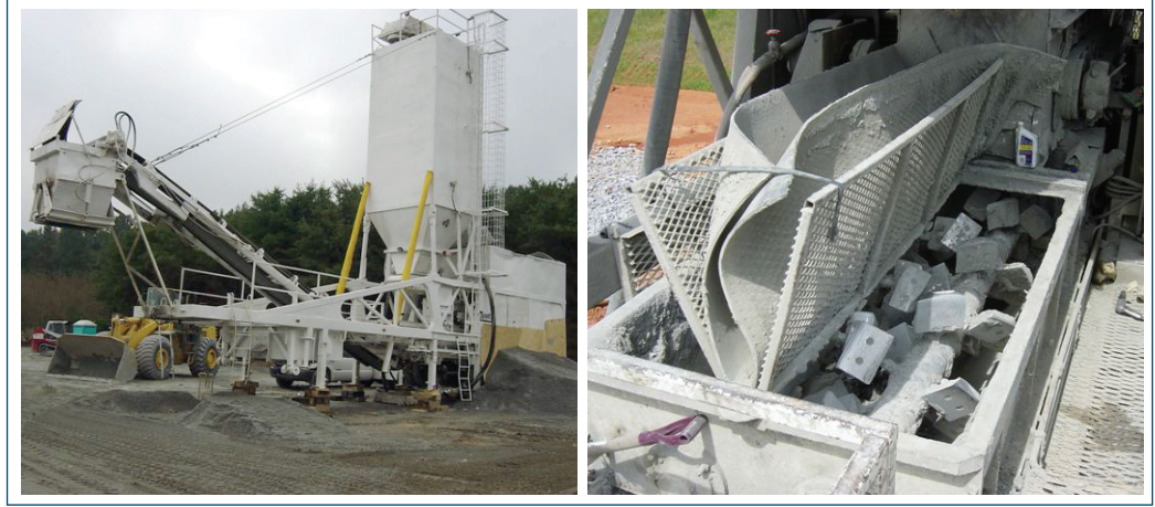
Şekil 6-4. Sürekli beslemeli karışım (sol) karışım odasından yakın görünümü (sağ)
