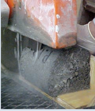
Donma ve çözünme testleri için SSB prizmaların hazırlanması (üst) ve yerleştirilmesi (alt)
