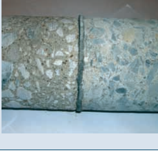
Geotekstil tabakayı da gösteren çok tabakalı yol karot
