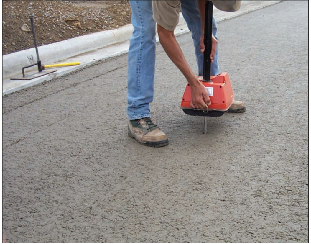
Şekil 7-3. Tek problu nükleer yoğunluk aletiyle yoğunluğun kontrol edilmesi
