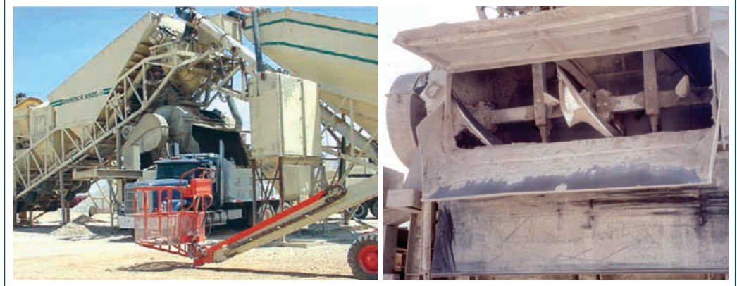
Şekil 6-5. Yatay şaft mikser (sol) karışım odasından yakın görünümü (sağ)
