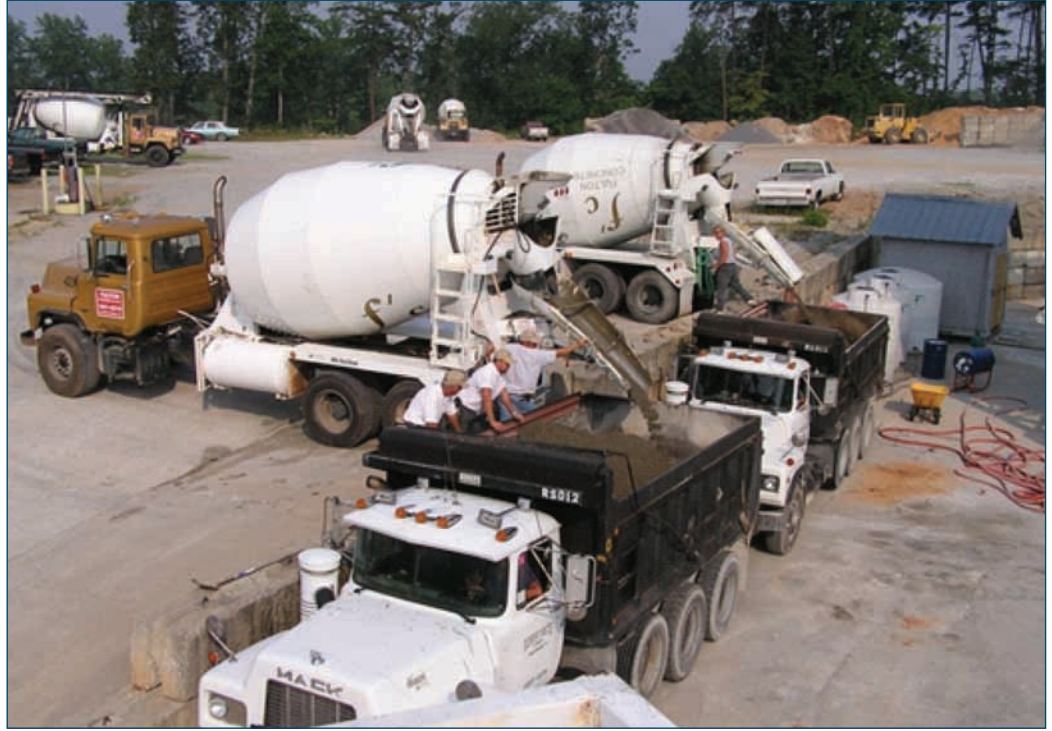
Şekil 6-3. Transmikserler kamyona karışımları dökerken
