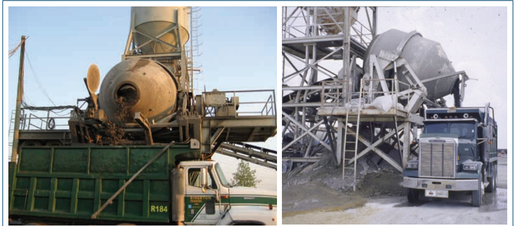
Şekil 6-2. Eğimli döner mikser hazneleri
