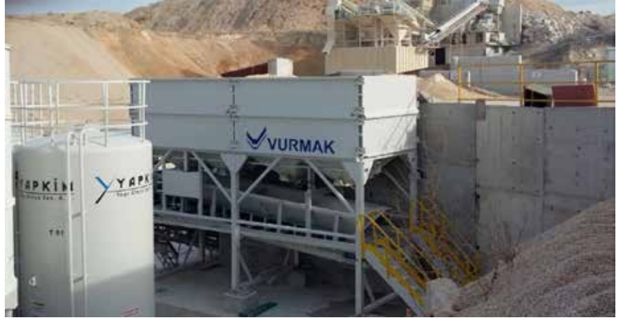
7. Yeşilçomlu hazır beton tesisi ilave bunker, agrega stok, yol ve sulama sistemi çalışmaları
